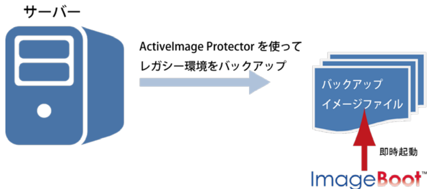
図 6 レガシー環境のバックアップと即時起動
